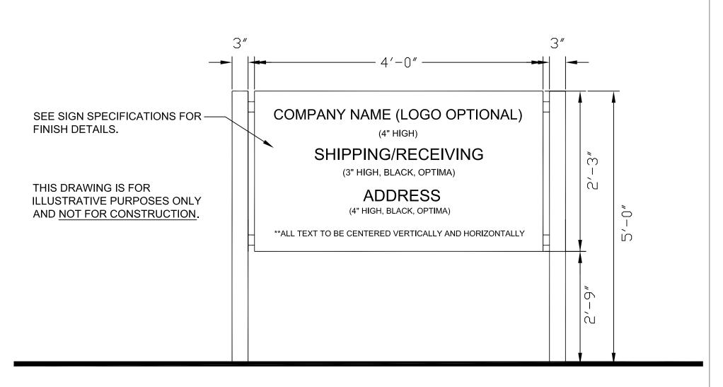
AUXILIARY SIGNAGE - FRONT ELEVATION (TYP.)
